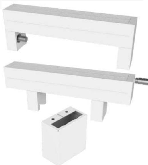
Bei Ventilanschlüssen VR VL mit seitlichen Heizmittelleitungen im Abstand von 50 mm werden die Blockständer 150 mm vom Konvektor Rand entfernt positioniert. Die Höhe des Standfuß - Block beträgt 140 mm.
