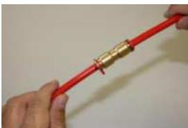
Überprüfen Sie, ob das Rohr sicher eingesteckt ist. Dies ist durch Gegenziehen leicht möglich.
