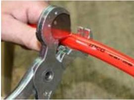
Rohr rechtwinklig abschneiden und sicherstellen, dass keine Grate, scharfe Kanten oder andere Beschädigungen vorhanden sind. Rohrende muss sauber abgetrennt sein.
