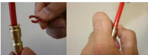
Lösen der Verbindung
