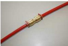
Rohr bis zur Markierung einstecken. Nur durch Einstecken bis zur Markierung ist gewährleistet, dass sowohl die Dichtungen als auch das Halteelement ihre Funktion erfüllen.
